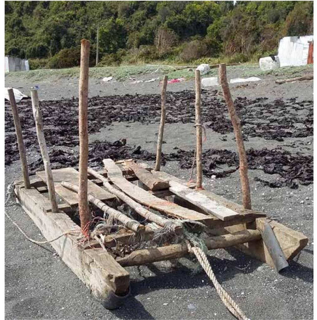
Virloche de madera utilizado para acarrear algas, isla Chuit. Es un gran trineo de madera con alta capacidad de carga que funciona mediante fuerza animal.
